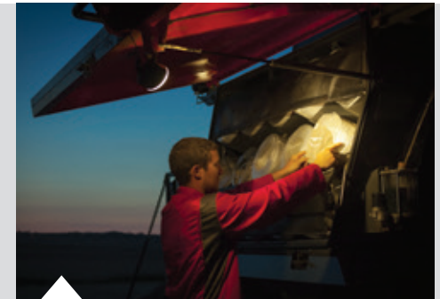
Compartiment à ficelle éclairé pour un réapprovisionnement facile de nuit.
