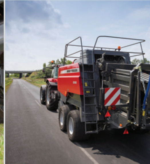
L'essieu tandem permet une vitesse élevée sur route et offre un grand confort de conduite entre les champs.
