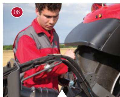
06 Graissage de l'arbre de PDF.
