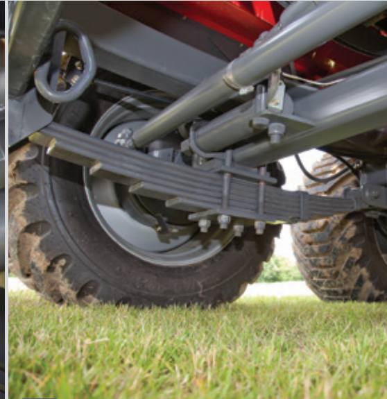
Suspension indépendante sur chaque roue par lames de ressort.
